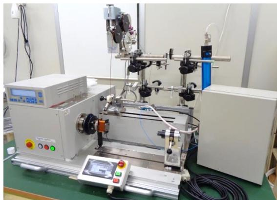
図2 「接着巻線」塗布装置
